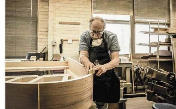
*Fabriquée à partir de longues plaques de bois souples accolées à la main puis pressées grâce à un procédé mis au point en 1880 (et à des machines d'époque encore utilisées), la ceinture du piano est ensuite poncée.*
